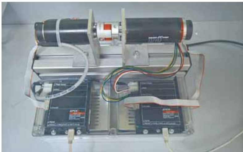
Рис. 2. Проверка соответствия характеристик электропривода при нагружении и разгрузке [Conformity verification of the actuator the characteristics during loading and unloading]
