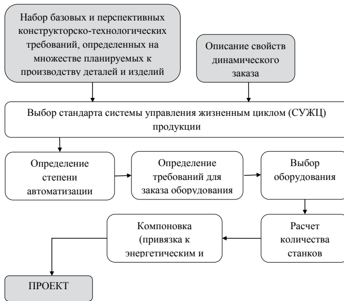
Рисунок 3. Предлагаемый подход к созданию проекта производственной системы
